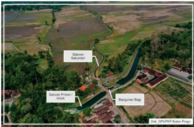
Gambar 10.1 Saluran primer (sumber : Arifin, 2022)
