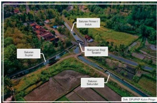
Gambar 10.2 Saluran sekunder (sumber : Fadila, 2019)
