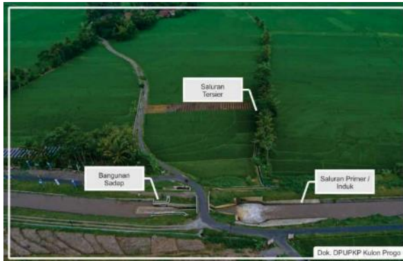
Gambar 10.3 Saluran tersier (sumber : Hadhiswoyo, 1999)
